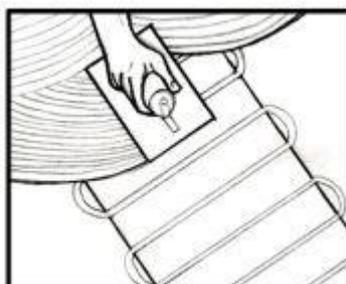
Fliesenkleber oder selbstnivellierenden Estrich über den Heizmatten verteilen
